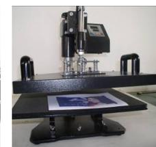
Нагревательный элемент для тиснения
